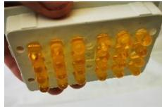
**6.** Nehmen Sie das Oberteil mit den gefüllten Kapseln heraus und halten es über die Trockenschale. Drücken Sie mit beiden Daumen auf die weiße Plastikplatte. Sollten die Kapseln nicht sofort herausfallen, können Sie die Federplatte entfernen und mit dem Stampfer die Kapseln von innen nach außen drücken, damit sie in die Trockenschale ausgeworfen werden.
